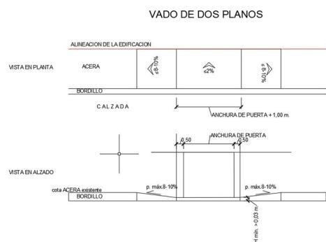
En cualquiera de los casos el bordillo en la zona del vado de acceso tendrá una altura mínima de 3 cm. con respecto de la calzada y la longitud total del vados correspondiente a la anchura de la puerta de acceso más 50 centímetros a cada lado de la misma.
